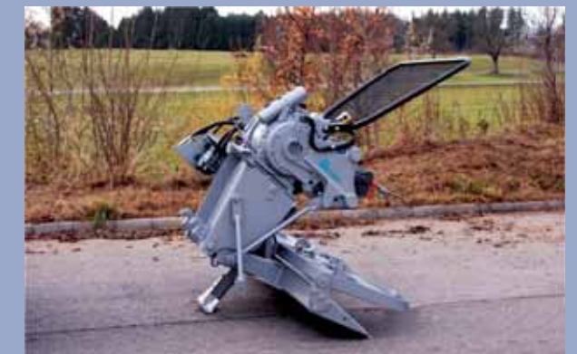
Beim Abbau der Seilwinde, der ca. 15 min dauert, wird kein fremdes Hubgerät benötigt.
