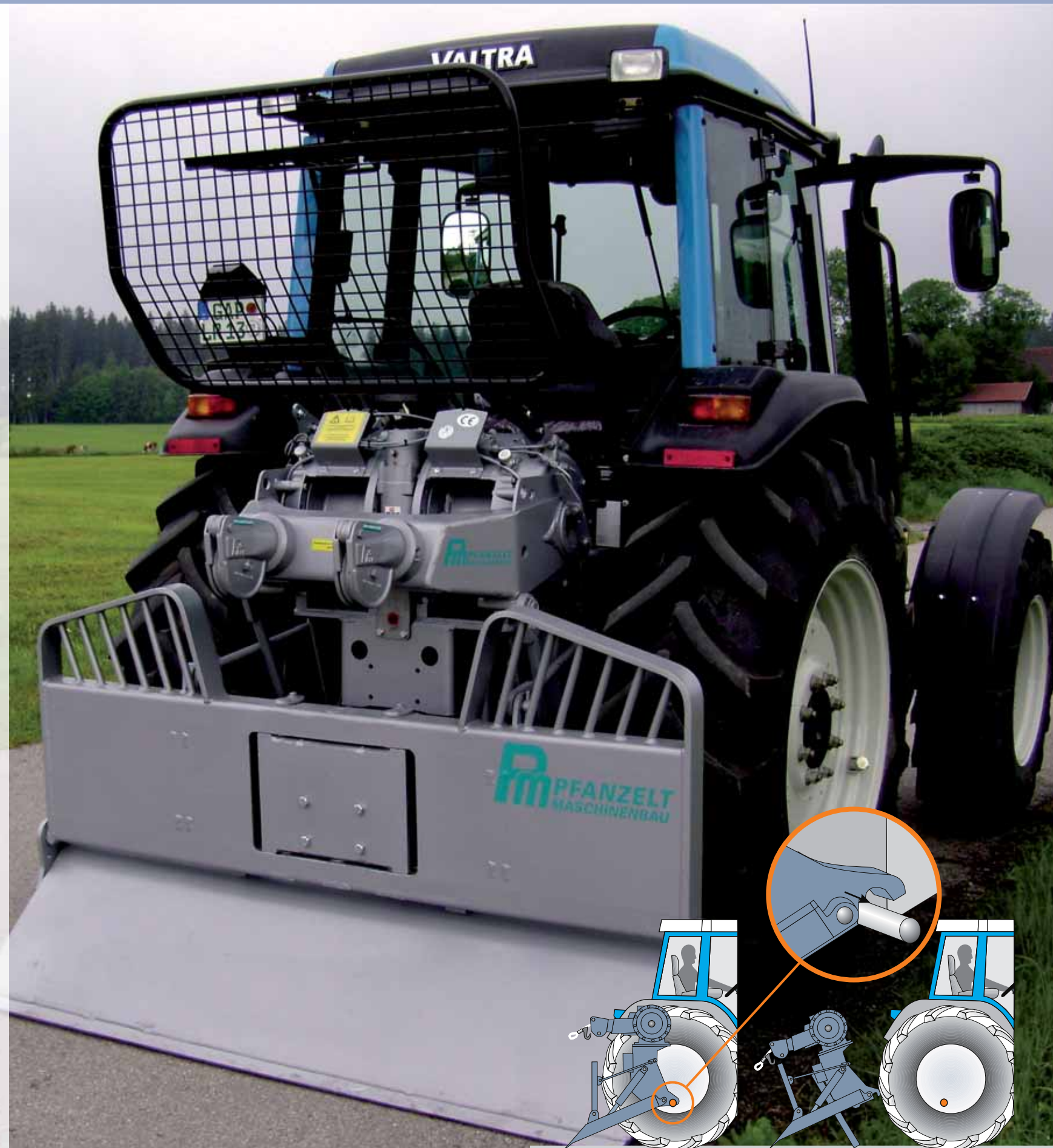
Beim Abbau der Seilwinde, der ca. 15 min dauert, wird kein fremdes Hubgerät benötigt.
